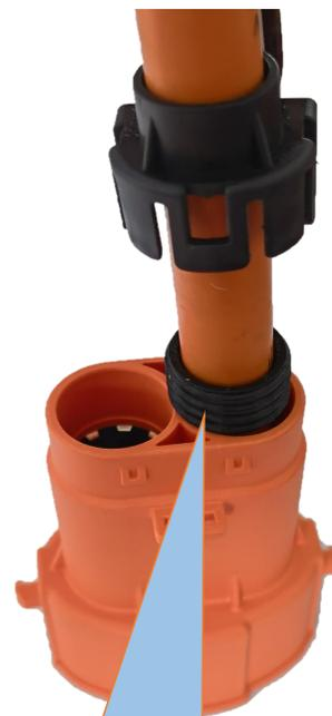
导线截面与密封件截面均为圆形，橡胶密封件胶位一致在导线插入密封件时，360°的扩张系数一样，压缩量均匀，满足产品设计压缩比，防水效果好，使用寿命长。
