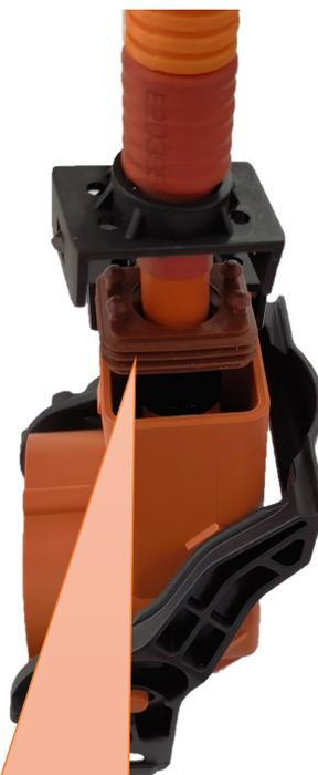
导线截面为圆形，密封件截面为长方形，橡胶密封件圆心与四边胶位不一致。在导线插入密封件时，密封件圆心对胶位360°的压缩量不一样，造成密封件各处厚薄不均，尤其在密封件的直角处，容易造成防水失效。
